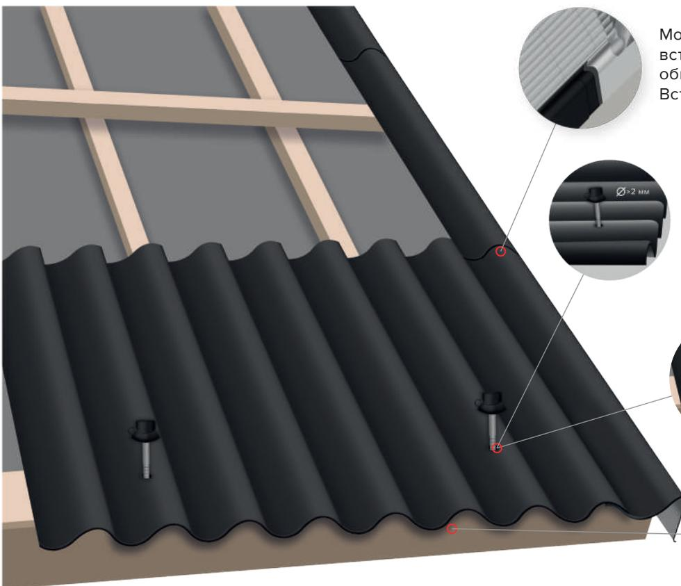
Монтаж покрівлі починається з встановлення вітрової планки по обидві сторони скату. Встановлюються знизу вгору.
