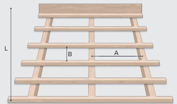
При потребі використовується гідроізоляційна плівка, що стелиться по кроквах і закріплюється контрлатою. Відстань між центрами обрешітки залежить від кута нахилу даху. Розмір перерізу крокви залежить від її довжини (L) та відстані між самими кроквами (А).
